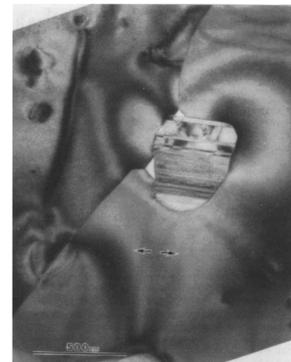
Fig. 28 : Microstructure d'un nanocomposite alumine-17 % vol. SiC après fluage (1300 °C, 50 MPa) [19].
